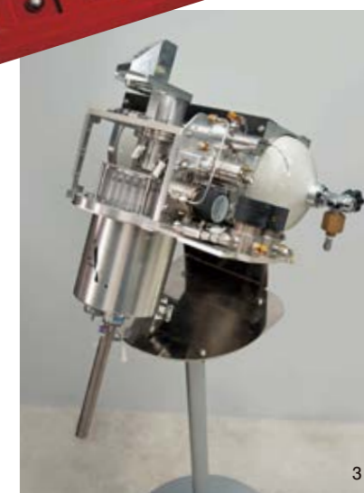
1. Okajima posa con una maqueta de un satélite lanzado por ALE. 2. Okajima realiza experimentos para la funcionalidad del satélite. El funcionamiento del satélite y el suministro de energía se controlan mediante instrucciones del personal de tierra. 3. El satélite consta de componentes para el sistema de misión y una sección que libera las partículas de meteoritos (en la foto superior). 4. Representación artística de la caída de estrellas fugaces artificiales. (Foto: ALE Co., Ltd.)
