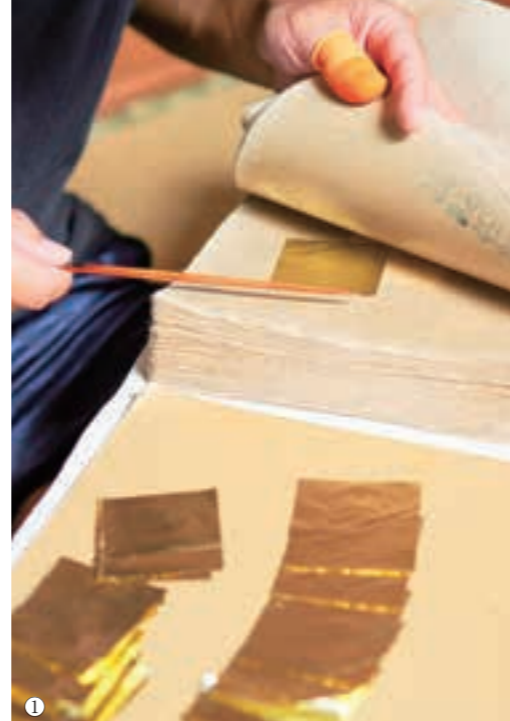
1. 将切开的金箔一张张夹在1800张箔打纸之间
