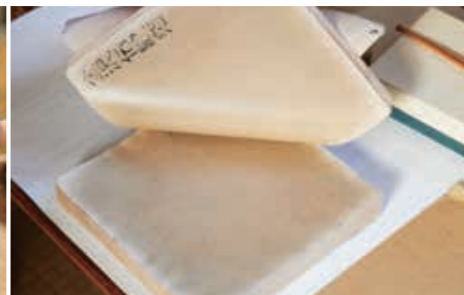
箔打纸决定金箔的质量，制作这种纸非常耗时耗力
