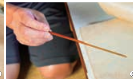
6. 由于金箔触碰易碎，所以使用的都是不受静电影响的竹制专用工具
