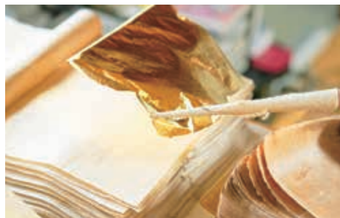
金箔要打薄到近似透明，甚至能看到背面的程度，需要工匠多年的经验与技巧
