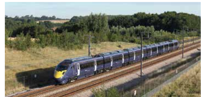
ロンドンと英仏海峡トンネルを結ぶ高速新線を走る日本製車両。在来線と高速専用線の両方を自在に走れる
