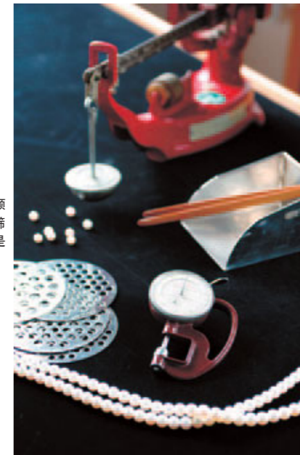
测量直径的仪器、用于颗粒大小分类的带洞眼的筛选板“FURUI”等，都是珍珠分选作业的工具。
