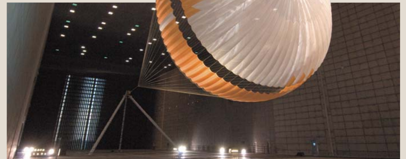
El paracaídas de aterrizaje de la sonda espacial Curiosity desplegado durante un experimento en el túnel de viento. Las cuerdas de suspensión que conectan el paracaídas y la sonda especial están hechas de una fibra de aramida llamada Technora que ha sido desarrollada por Teijin Ltd. (Foto por cortesía de NASA/JPL-Caltech)
