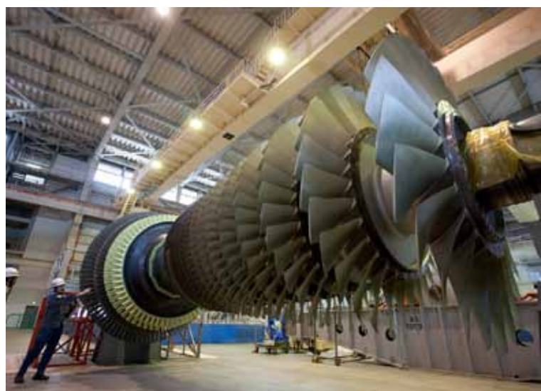
Una turbina de gas que se utiliza en la generación de ciclo combinado (foto de Kawamoto Seiya).
