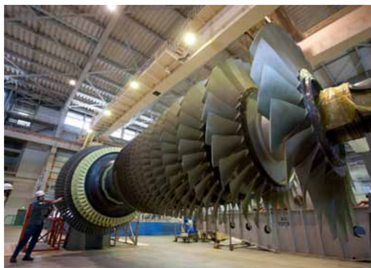
Une turbine à gaz utilisée dans la production d'électricité par cycle combiné. (Photo : Kawamoto Seiya)
