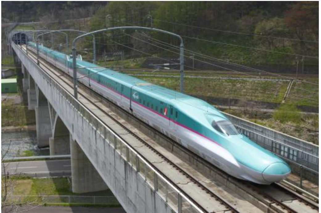
신칸센 도쿄-아오모리 간을 운행하는 신칸센 '하야부사'. 최고시속 320km. (사진제공: Railman Photo Office)
